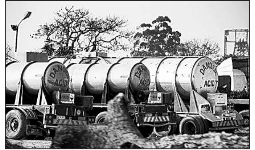
Dans des camions, l'acide utilisé en quantité pour extraire le cuivre.
